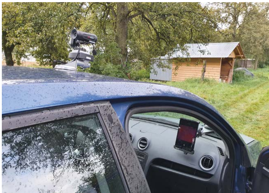
Obr. 29: Termovizní monokulár nainstalovaný na autě
