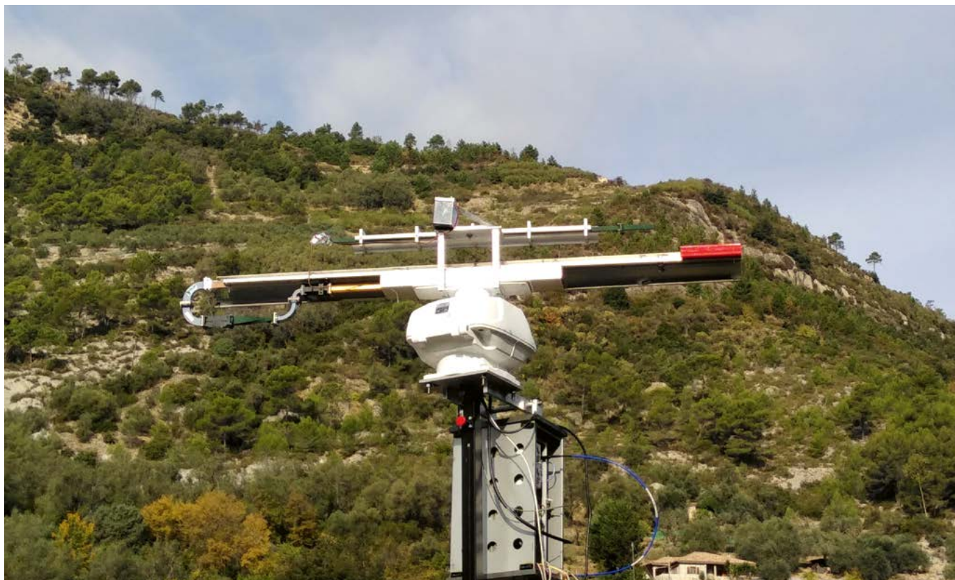
Obrázek 8: Harmonický radar vyvinutý v rámci projektu STOPVESPA [© LIFE STOPVESPA].
